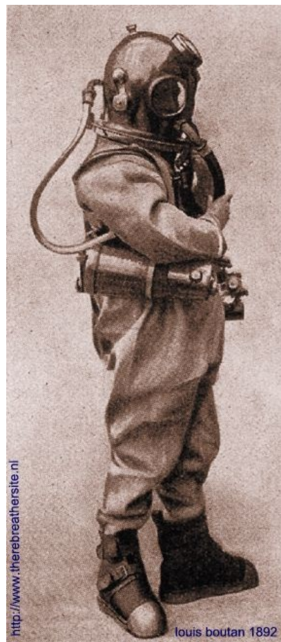
O escafandro de circuito fechado a oxigênio desenvolvido por Boutan. A data pode não ser exata.
